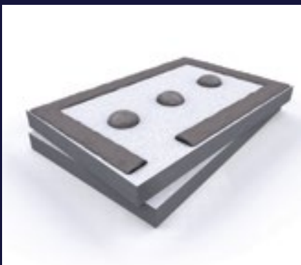
2 Distribución de mortero cola RHONA T-700 sobre los paneles aislantes.
