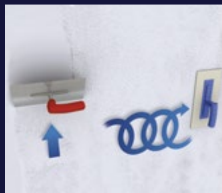
12 Aplicación de capa de acabado con un mortero acrílico, una vez seca la imprimación.
